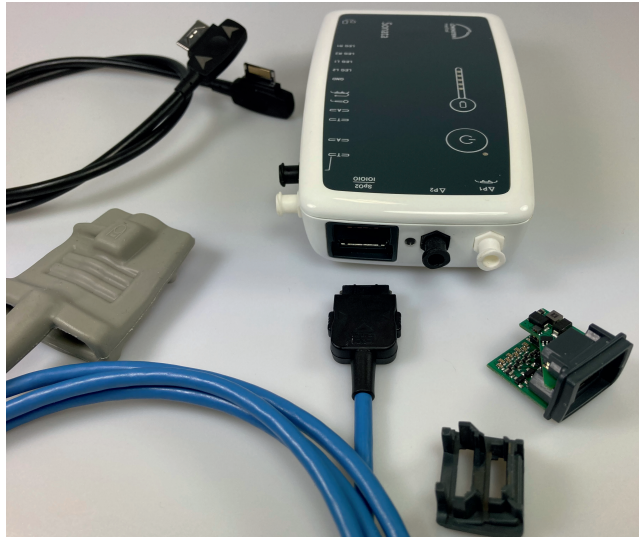
Bild 2. Schlafdiagnostik-Stilleben: Neben dem Gerät samt Hilfsrahmen ist hier auch der SpO 2 -Sensor sichtbar: der Silikon-Fingerling am einen Ende des blauen Kabels und am anderen Ende der neue Stecker. © Nicolay
