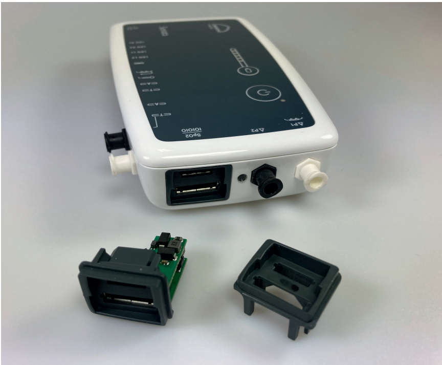
Was tun, wenn die Steckverbindung die Anforderungen nicht erfüllt? Der Hilfsrahmen mit und ohne Platine und eingebaut im Gerätegehäuse. © Nicolay
